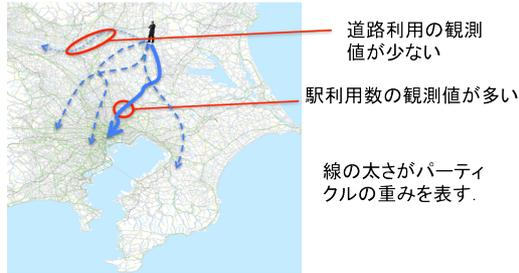
図-4 パーティクルフィルタ法による重み付け
